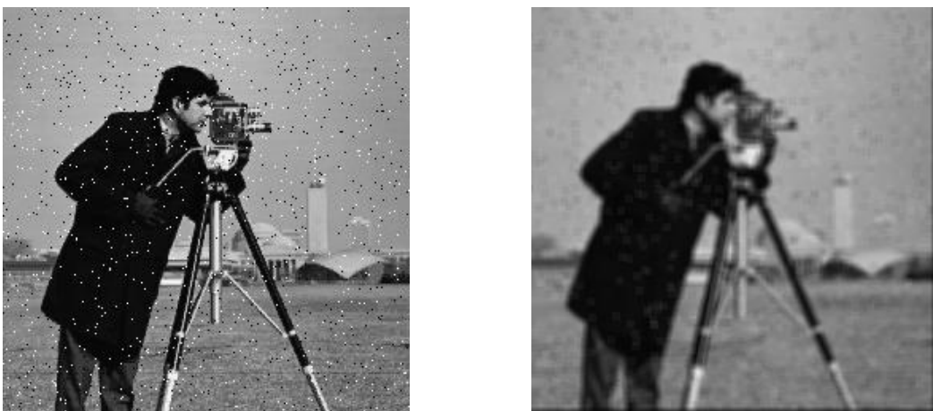
Σχήμα 13. Αρχική εικόνα με θόρυβο τύπου 'Salt & Pepper' 2% και απομάκρυνση του με χρήση φίλτρου μέσου όρου με N=5 .
