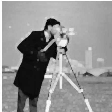
Σχήμα 14. Η εικόνα 'cameraman' μετά από πέρασμα από φίλτρο ελαχίστου και μεγίστου με παράθυρο γειτονιάς μεγέθους 5 \times 5
